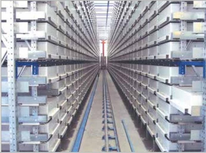
**Impianti speciali** per pallets, contenitori e cassette composti da scaffalature e trasloelevatori che guidati da software gestionali pianificano tutte le operazioni di prelievo e stoccaggio.
