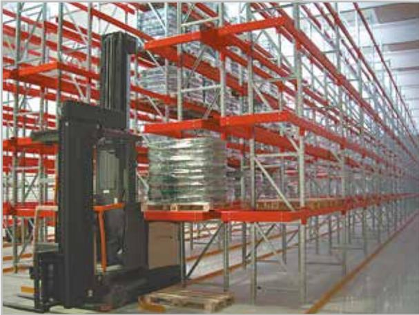
La scaffalatura ad incastro portapallet è il sistema tradizionale più utilizzato per lo stoccaggio semplificato. Il dimensionamento è determinato in funzione del tipo di carrello utilizzato e dalle caratteristiche delle unità di carico.
