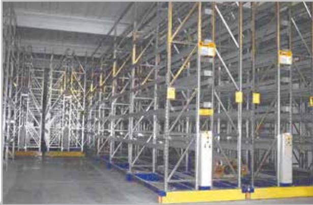
**Sistema compattabile** per il massimo sfruttamento di superficie e volume ideale in celle frigorifere e magazzini con funzionamento sicuro ed affidabile. Consente di ridurre al massimo le aree destinate alla movimentazione dei carrelli elevatori.
