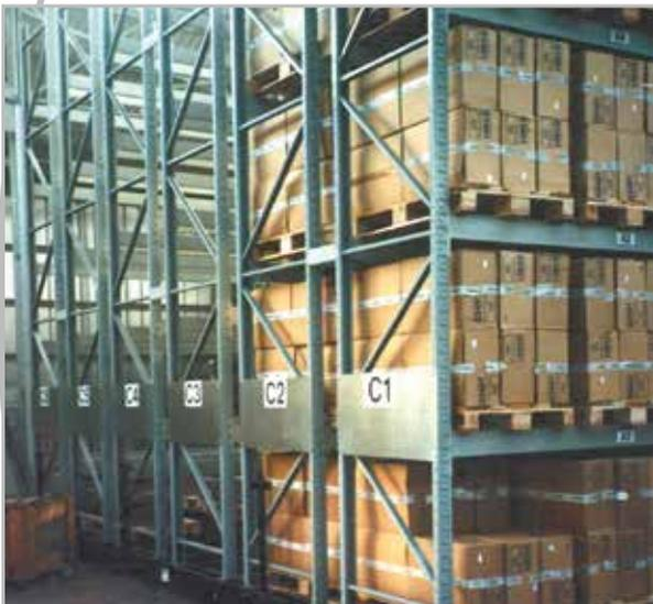
Composto da scaffalature tradizionali portapallets cantilever disposte su basi mobili motorizzate con movimentazione elettromeccanica, scorrevoli su rotaie incassate a pavimento disposte su più file.
